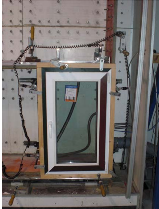
Fotografía 1: Vista general durante el ensayo de permeabilidad al aire
