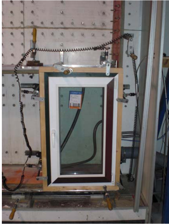
Fotografía 2: Vista general durante el ensayo de permeabilidad al aire (repetición)
