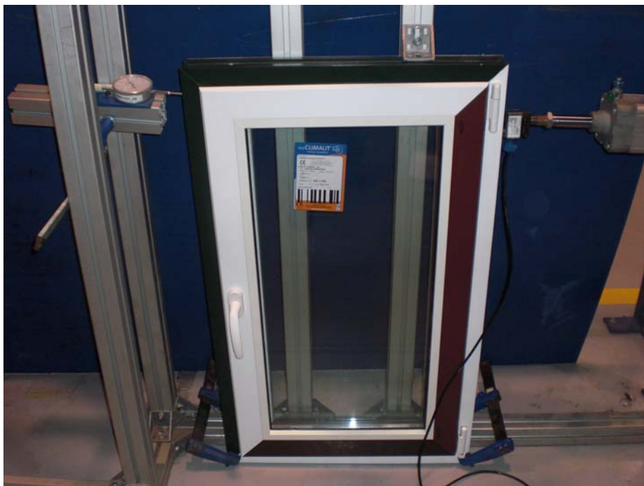
Fotografía 4: Vista general durante el ensayo de Resistencia sísmica (seguridad)
